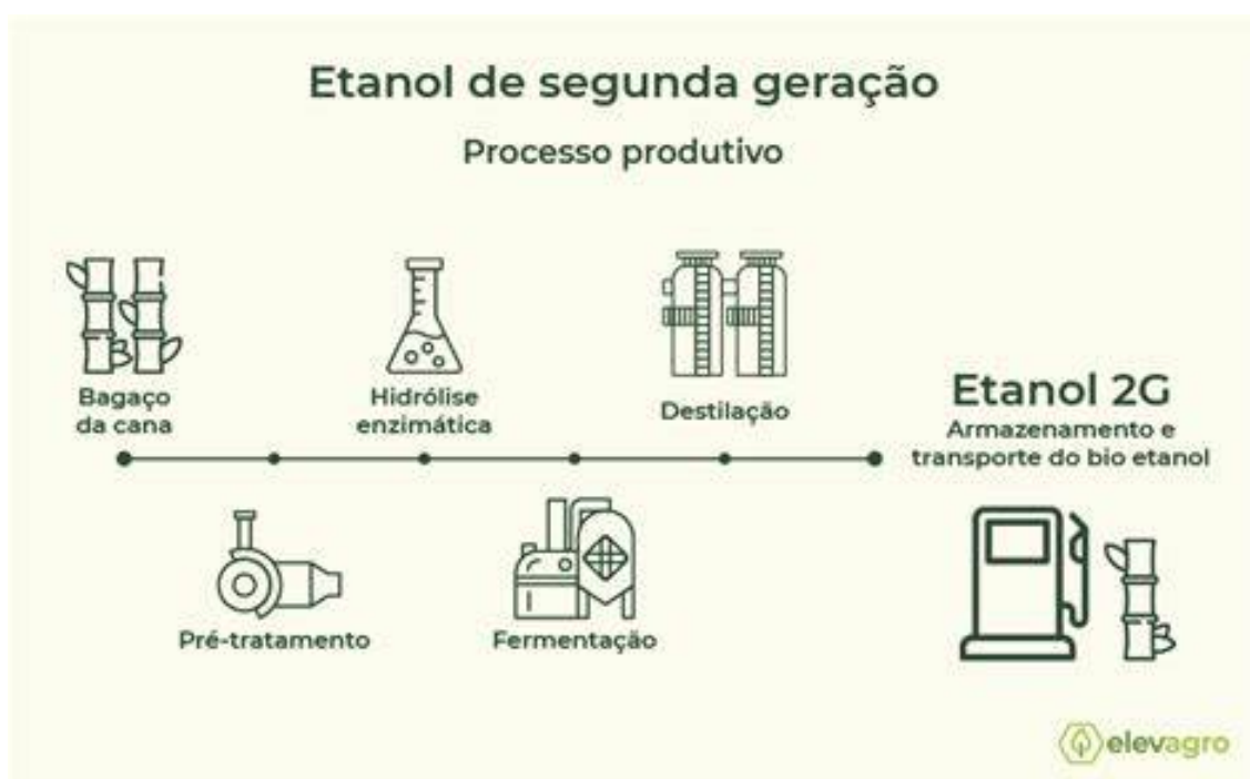
Figura 4 - Modelo de esquema das etapas da produção do etanol de 2 geração.
