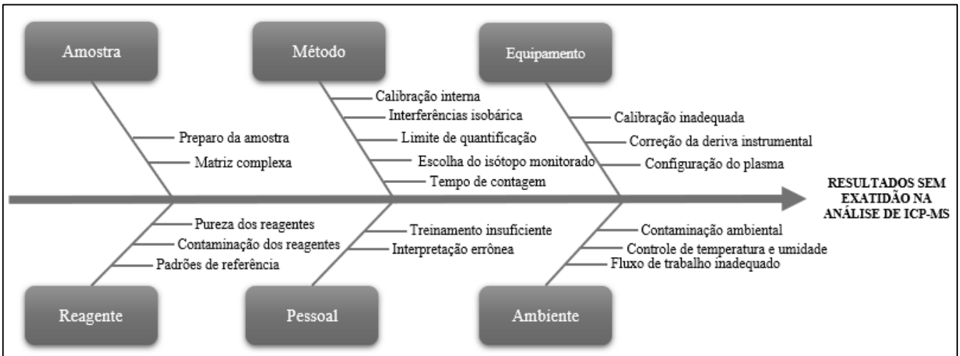
Figura 3. Causas dos possíveis resultados sem exatidão na quantificação dos elementos por ICP-MS.
