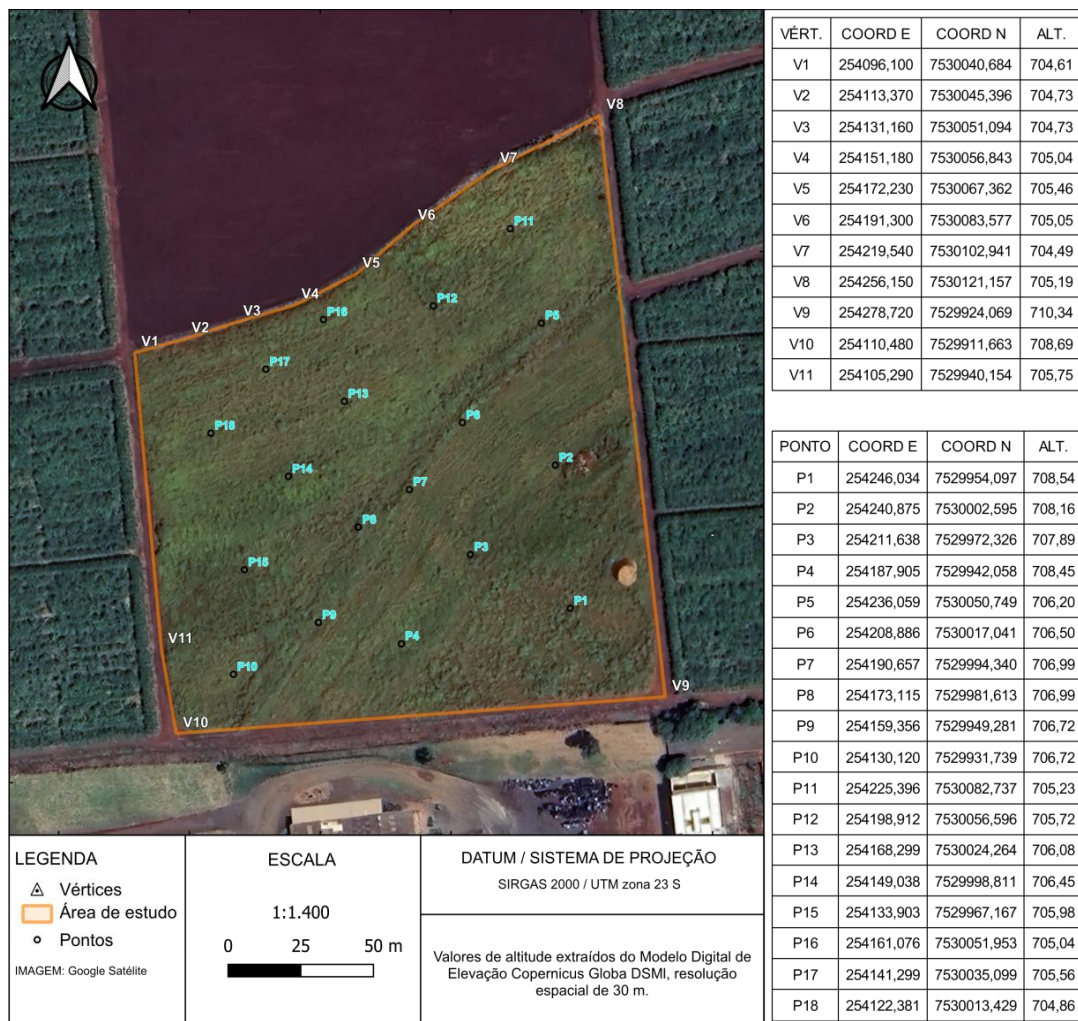
Figura 01: Coordenadas e altimetrias de pontos específicos da área de estudo utilizando o software QGIS.
