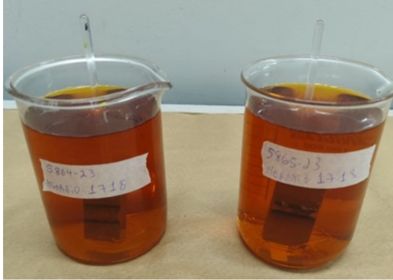
Figura 3.19 - Corpos de provas imersos em solução corrosiva para ensaio de corrosão por pites.
