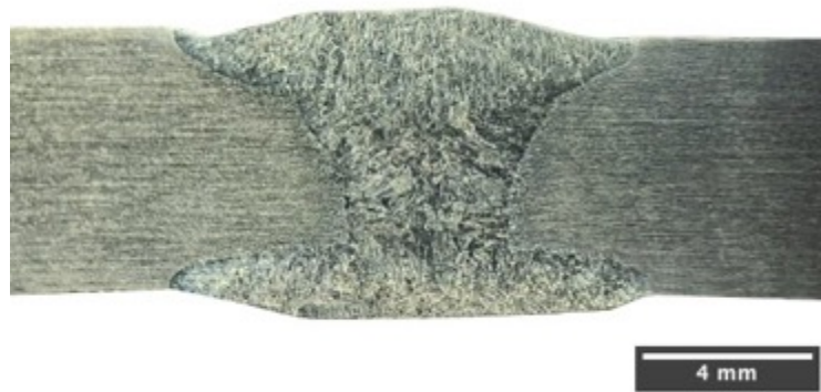
Figura 4.11 - Macrografia da junta soldada pelo processo GTAW Convencional.
