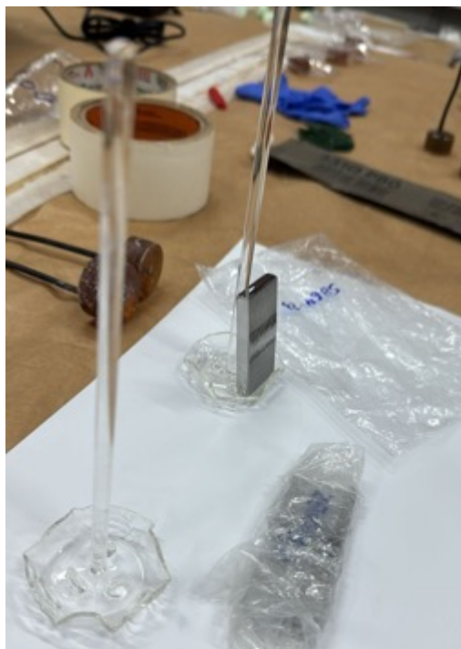
Figura 3.18 - Aparato de posicionamento da amostra no banho para ensaio de corrosão por pites.
