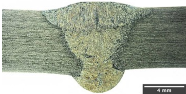
Figura 4.12 - Macrografia da junta soldada pelo processo GTAW Dupla Fusão.
