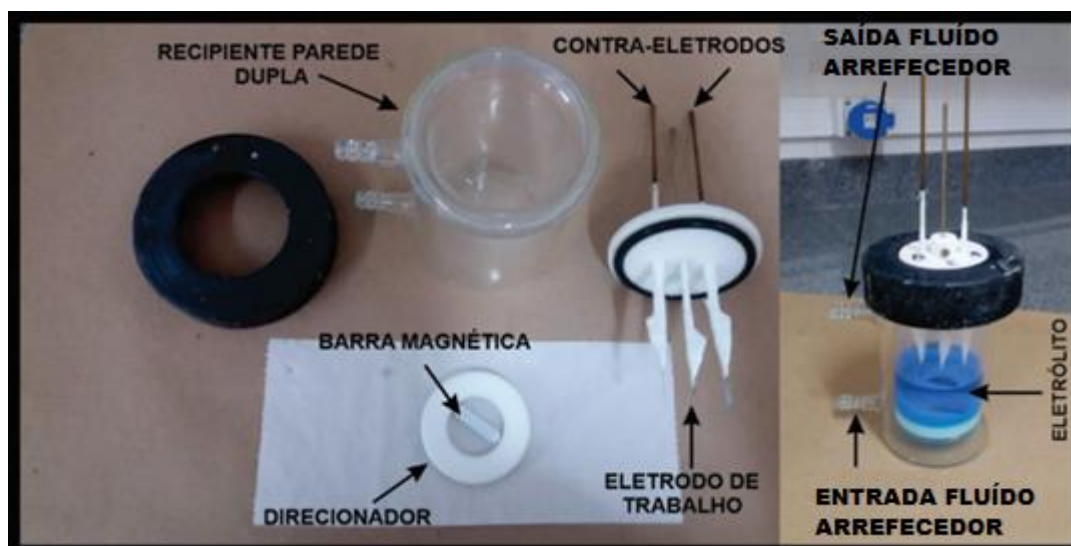
Figura 11 - Esquema do detalhamento do reator de PEO e seus respectivos componentes.
