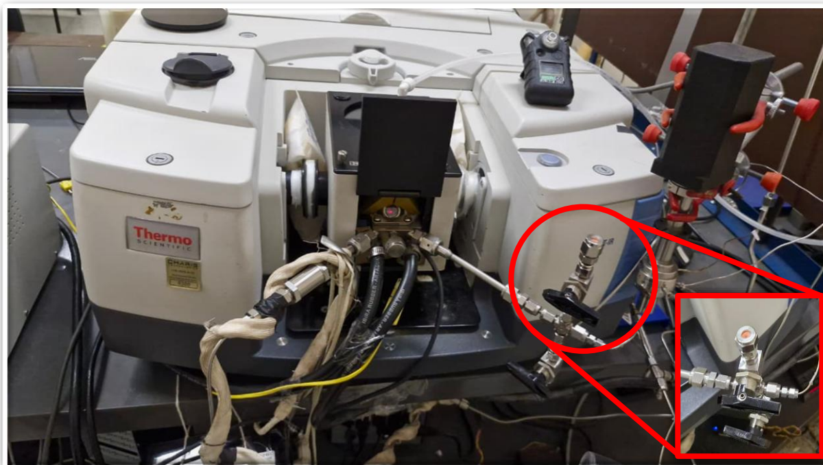
Figura 9 – Espectrômetro de infravermelho utilizado nos experimentos. Em destaque (vermelho): arranjo experimental para injeção de compostos voláteis com uso de seringa.
