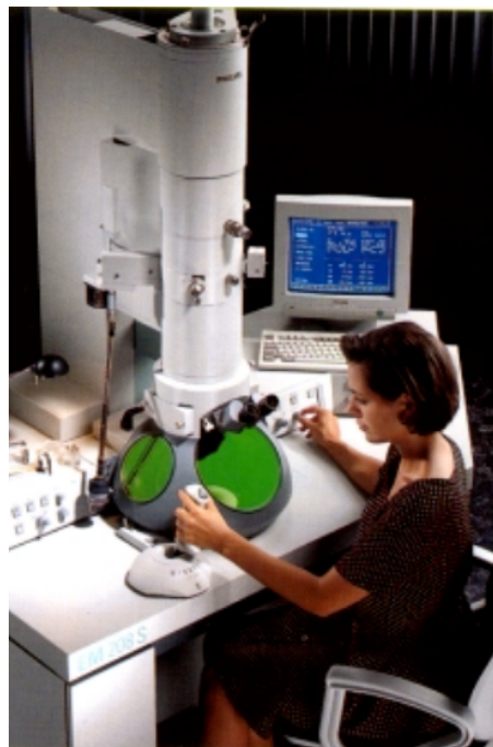
Figura 6 - Microscópio eletrônico de transmissão modelo EM 208S da Philips.
