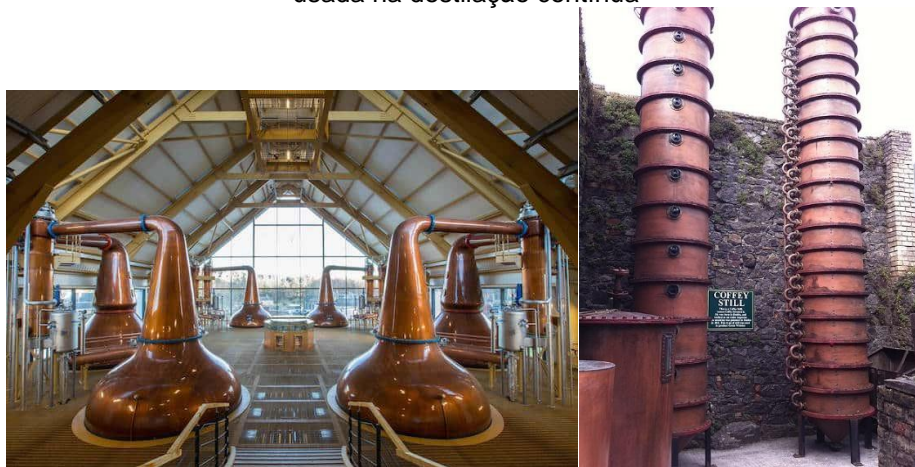
Figura 2 – À esquerda, alambique de cobre da destilaria Dalmunach, em Moray, no Reino Unido, usado na destilação do uísque em batelada. À direita, Coluna Coffey da destilaria Kilbeggan, Irlanda, usada na destilação contínua
