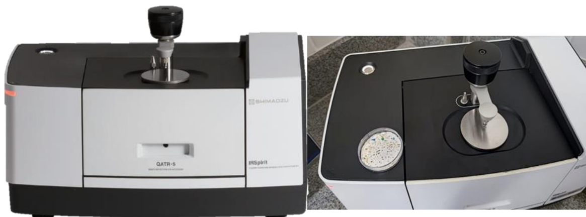
FIGURA 6.20- Equipamento de espectroscopia no infravermelho com transformada de Fourier com módulo de ATR.
