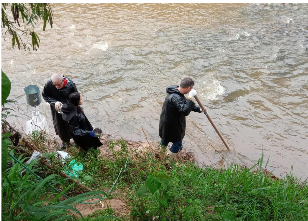
FIGURA 6.10- Representação do procedimento de amostragem de sedimento.
