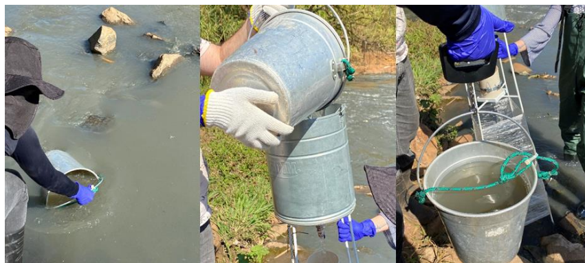
FIGURA 6.9- Representação esquemática do procedimento de amostragem de água e aferição da massa coletada.
