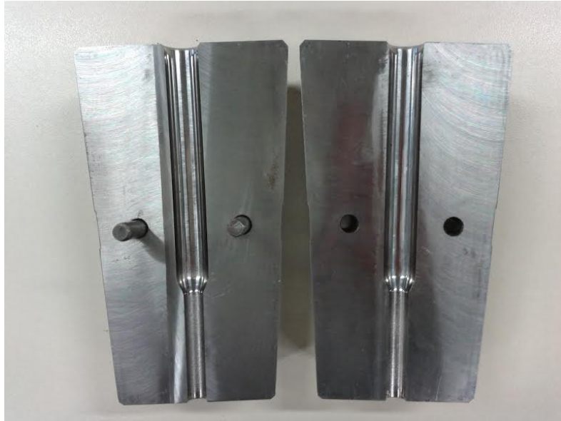
Figura 4.2 Matriz com alterações no projeto para facilitar a extrusão
