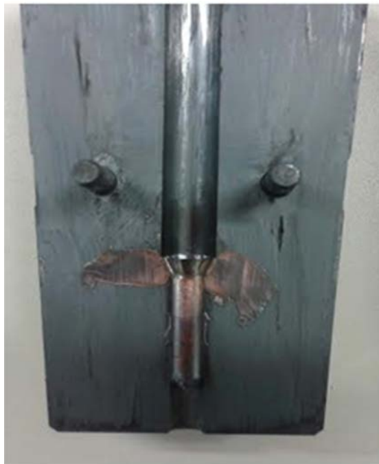
Figura 4.3 Amostra extrudada ainda dentro da matriz.
