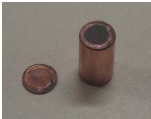
Figura 3.7 Amostra encapsulada em tubo de cobre.
