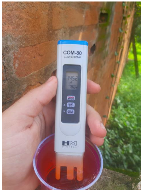
Figura 6: Medição da CE de entrada com o condutivímetro. Fonte: Autoria própria.
