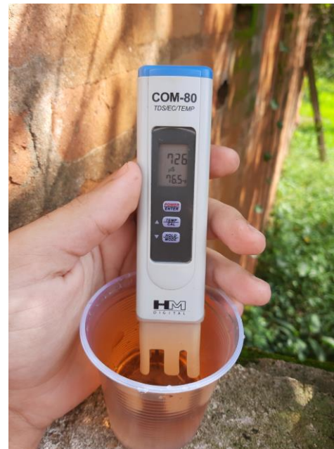
Figura 7: Medição da CE de saída com o condutivímetro. Fonte: Autoria própria.
