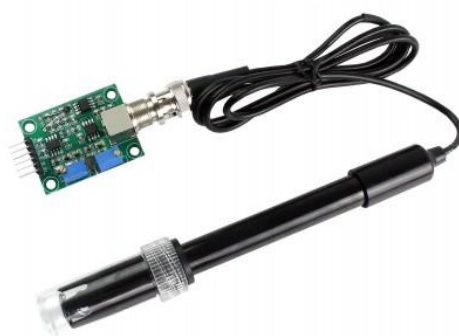
FIGURA 3. 6 - Sensor de pH para Arduino + Módulo de Leitura BNC PH4502C Fonte: Adaptado de UsinaInfo-PH
