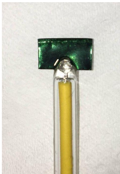
FIGURA 1. 16 - Eletrodo de Pt com Pani eletrodepositada para sensor de pH Fonte: A autora.
