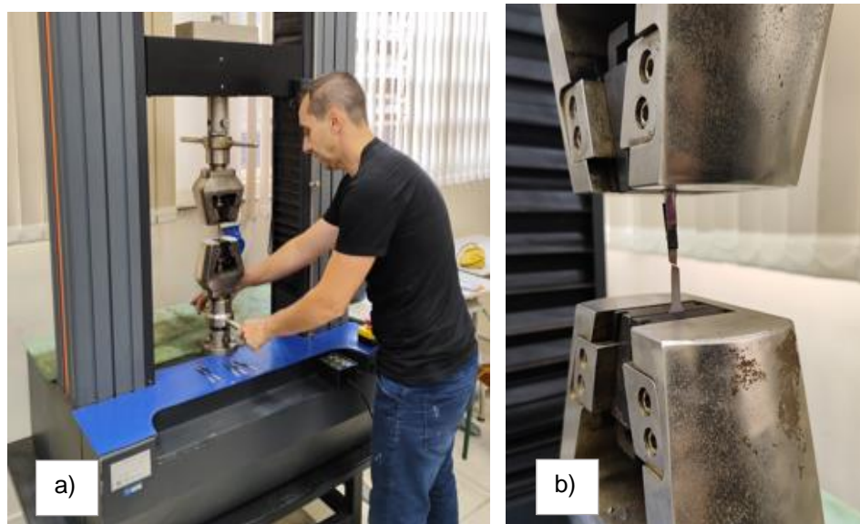
Figura 39 - Em a) preparação da máquina para os ensaios mecânicos de tração. Em b) corpo de prova rompido ao final de um ensaio.
