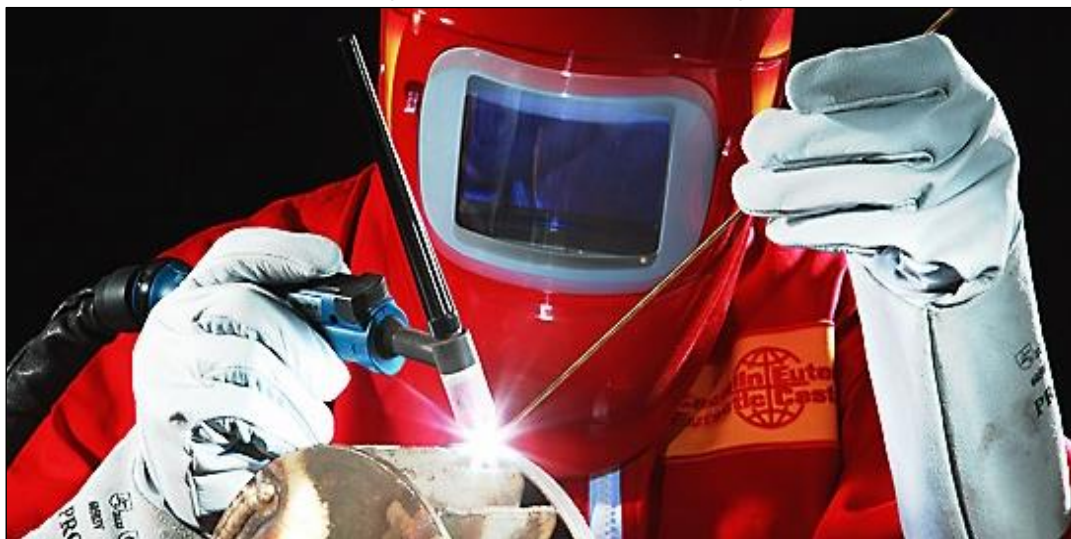
Figura 10 - Tocha Metal de adição gás arco metal base poça de fusão metal de solda.
