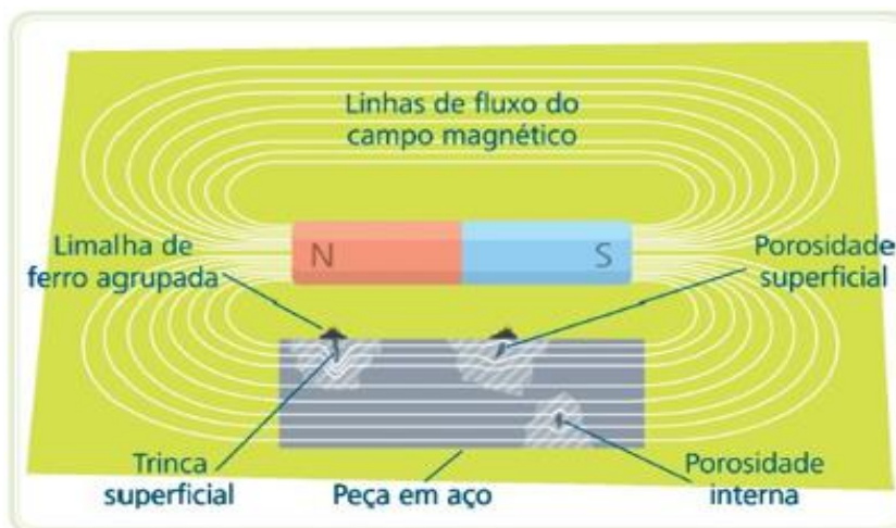
Figura 19 - Comportamento do campo magnético quando há falhas na peça.
