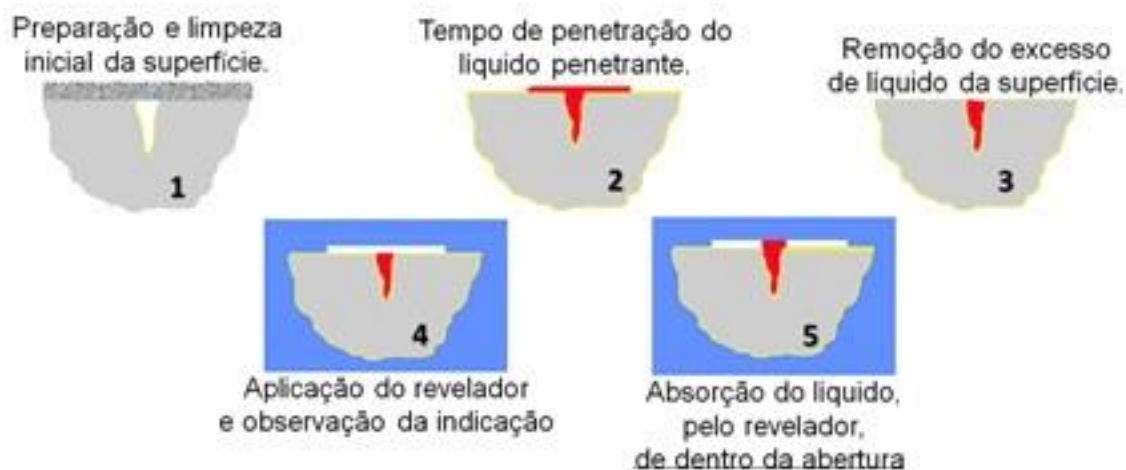
Figura 14 - Etapas da aplicação do ensaio líquido penetrante.
