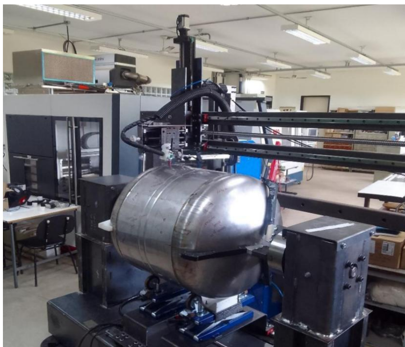
Figura 28 – Foto do protótipo de máquina de solda circunferencial automatizado do projeto SOLIS / EMBRAPII / UFSCar.
