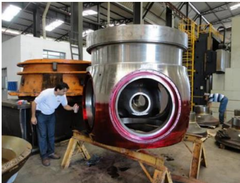
Figura 13 - Aplicação do líquido penetrante utilizando lata de aerossol.
