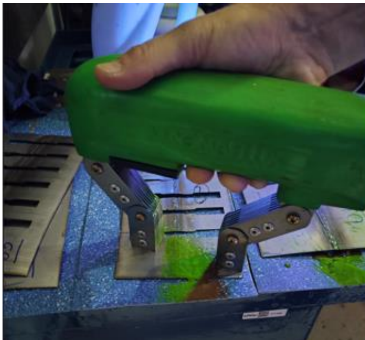
Figura 46 – Ensaio de Partículas Magnéticas.
