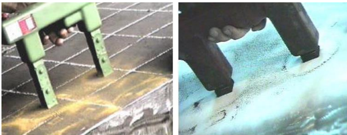
Figura 18 - Magnetização utilizando ferramenta Yoke.
