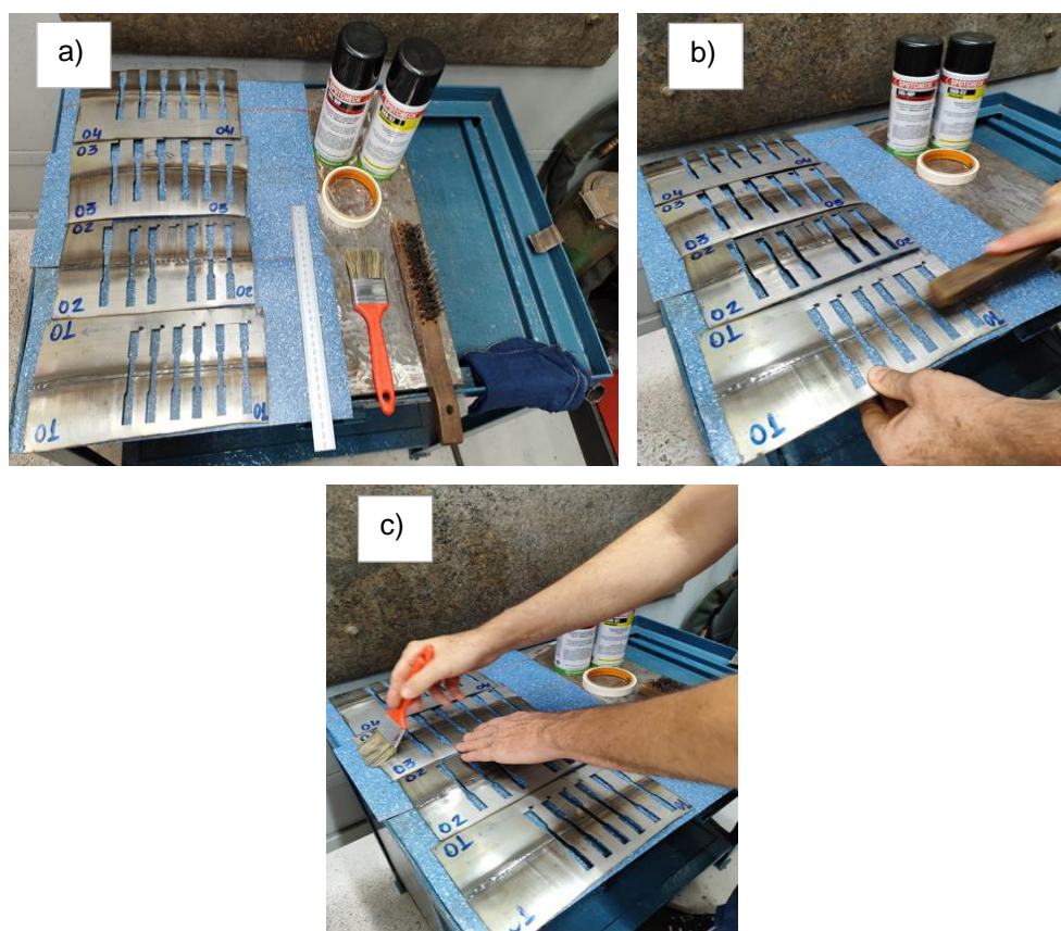
Figura 41 - Preparação da superfície para o ensaio de (LP). Em a) preparação para limpeza. Em b) escovação. Em c) aplicação de removedor.
