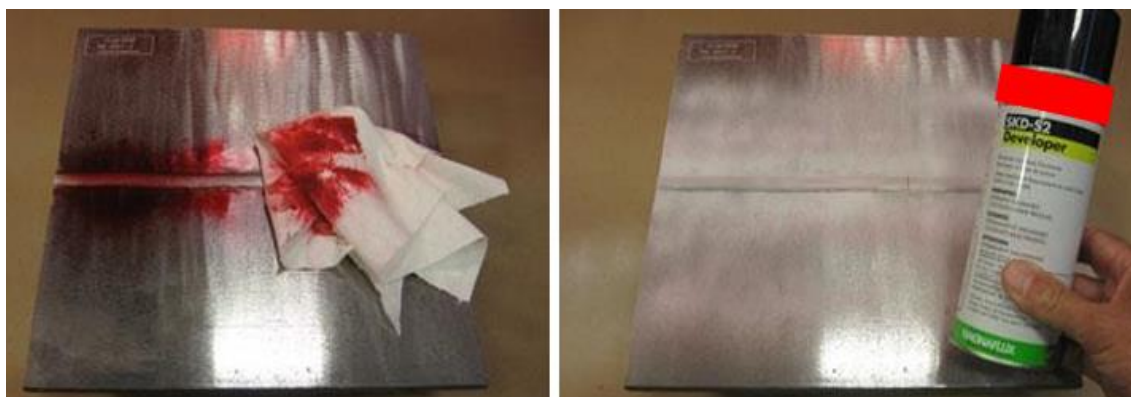
Figura 16 - Procedimentos remoção do líquido penetrante excedente e aplicação do revelador.
