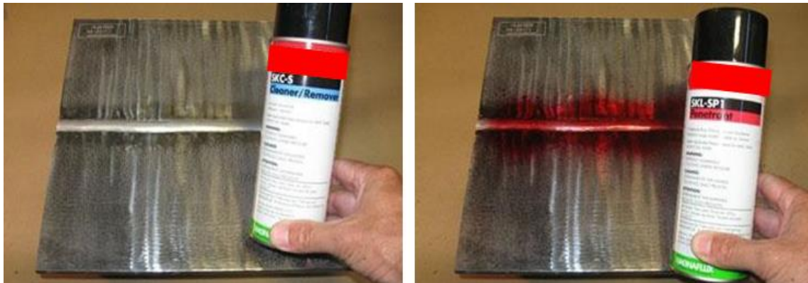
Figura 15 - Procedimento limpeza da peça e aplicação do líquido penetrante.
