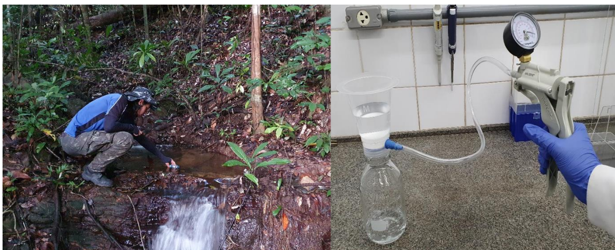
Figura 1.3 - Processo de coleta (esquerda) e filtragem da água (direita) para retenção do DNA disponível no ambiente.
