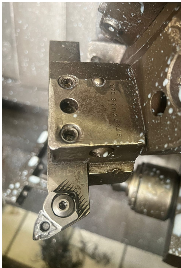
Figura 25 – Porta-ferramenta posicionado na máquina
