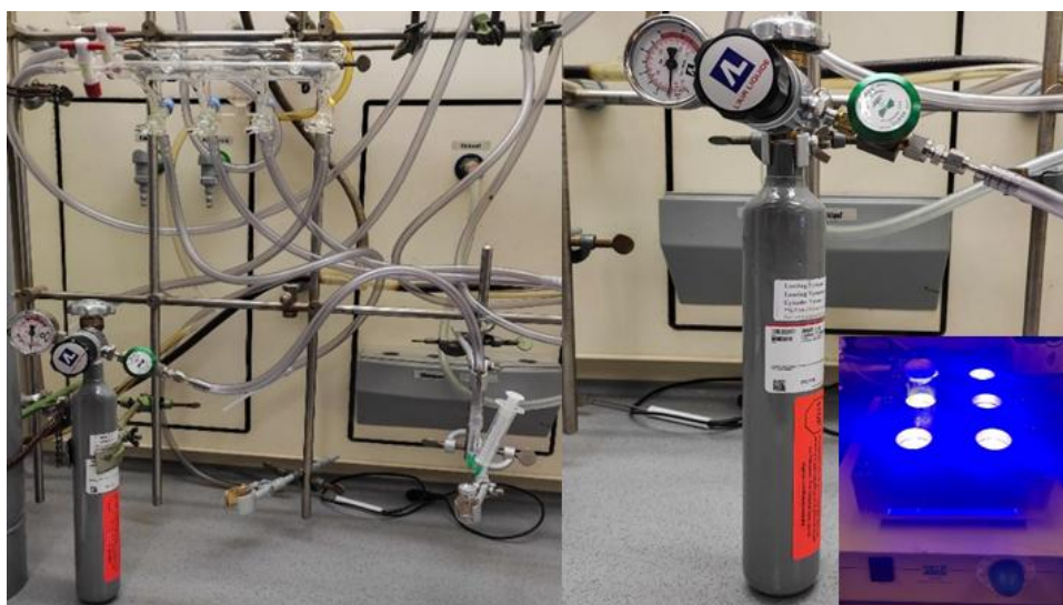
FIGURA S12.4. Configuração Experimental Fotocatalítica: Marcação isotópica de ^{13}\text{C} usando ^{13}\text{CO}_2
