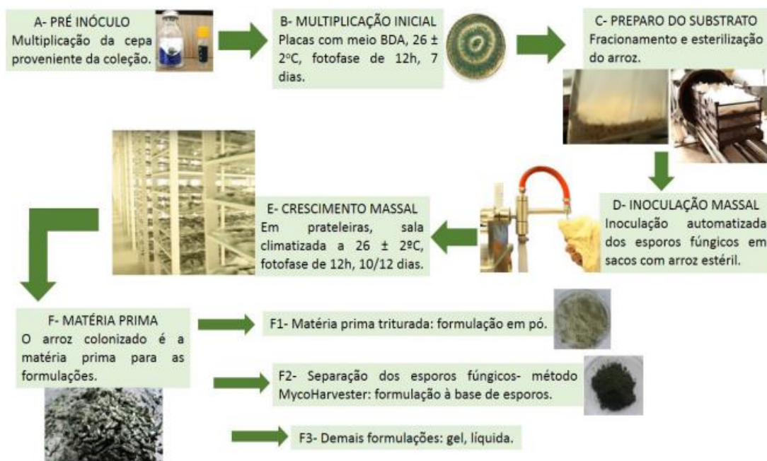
Figura 9: Representação esquemática do modelo de produção de fermentação do Trichoderma .
