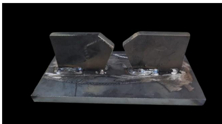
Figura 3- Dispositivo metálico constituído por três placas de ferro soldadas. Equipamento desenvolvido com base em modelo adaptado de dispositivo artesanal disponível em plataforma digital para a abertura de frutos e extração de sementes de D. alata . Protótipo desenvolvido por Elson Augusto Pereira.
