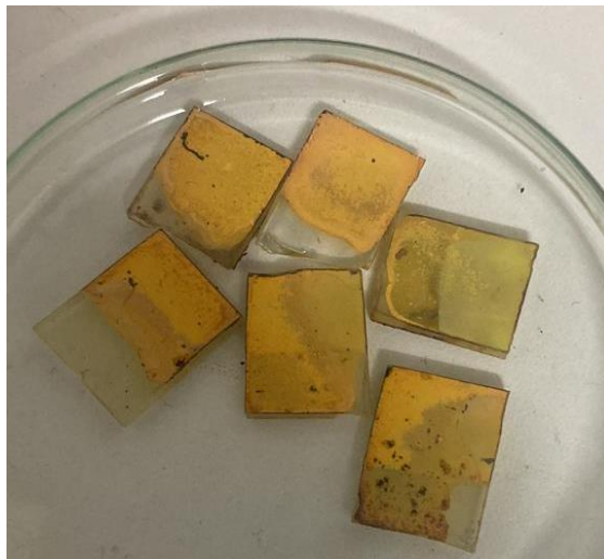
Figura 3.7: Eletrodo após o processo de calcinação.
