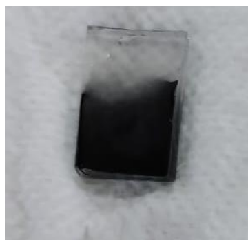
Figura 3.6: Eletrodo após a eletrodeposição de bismuto.
