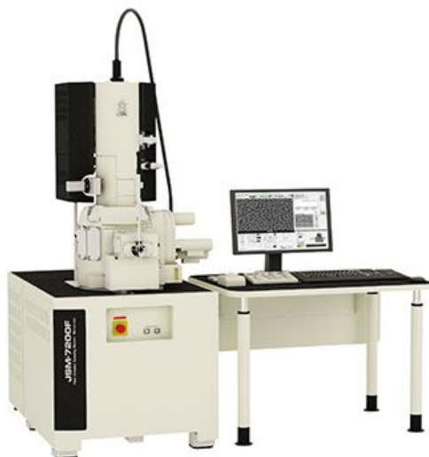
Figura 3.4: Microscópio de emissão de campo (FE - SEM, JEOL JSM - 7200).
