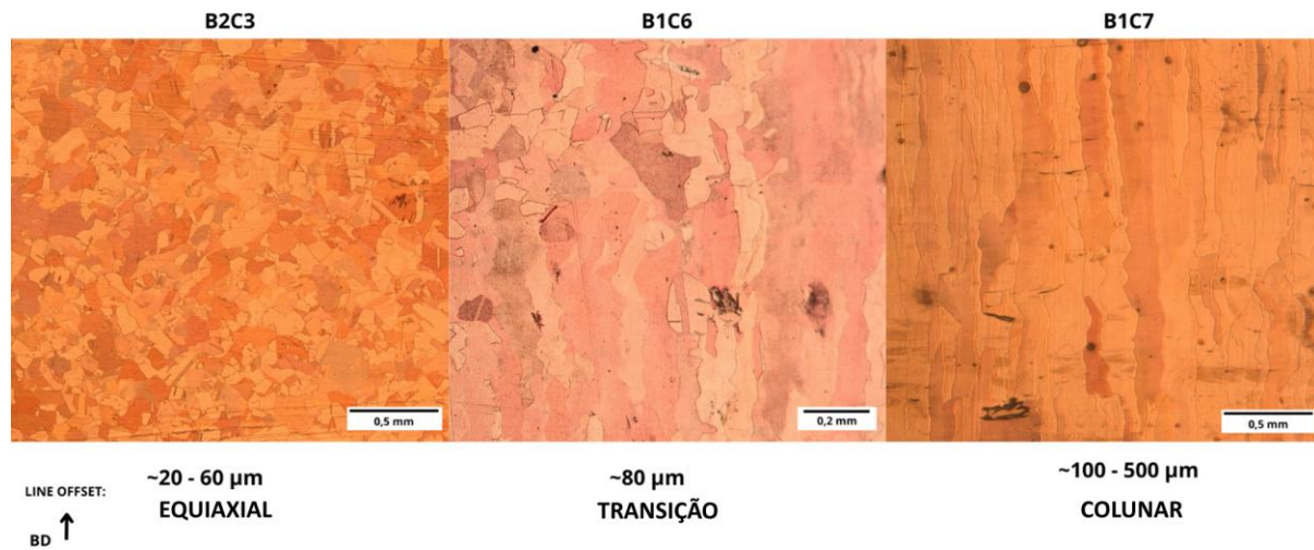
Figura 20 - Microestrutura equiaxial, de transição e colunar, respectivamente, determinadas pelo lineoffset
