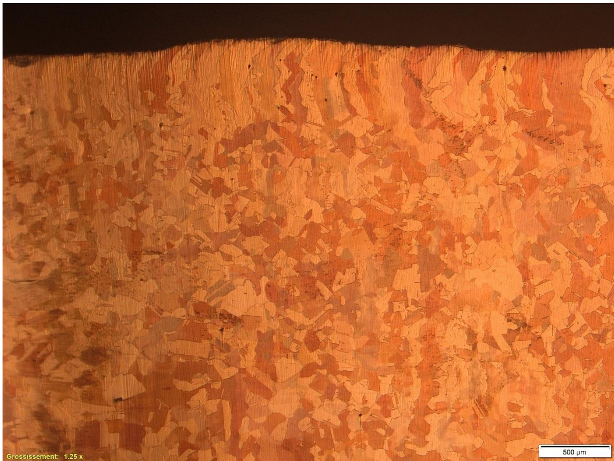
Figura 21 - Microestrutura do cobre puro processado por E-PBF. Imagem metalográfica evidenciando a transição microestrutural entre grãos equiaxiais na região inferior e estrutura colunar nas últimas camadas.
