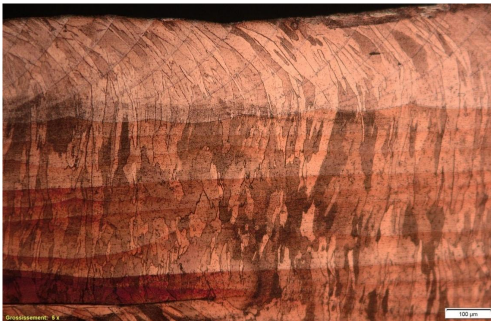
Figura 15 - Imagem de uma amostra de cobre puro obtida no microscópio óptico com um aumento de 5x, permitindo evidenciar tanto as poças de fusão quanto a microestrutura por meio dos ataques químicos.
