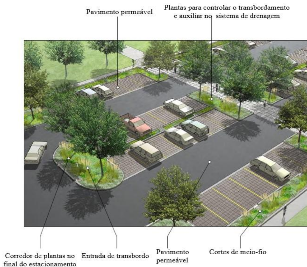
Figura 2.8 Exemplo de estacionamento com aplicações de drenagem sustentável
