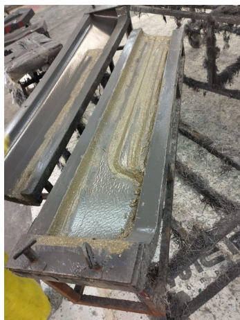
Figura 7 - Molde de peça contendo gel coat e mingau proveniente da formulação da amostra 3
