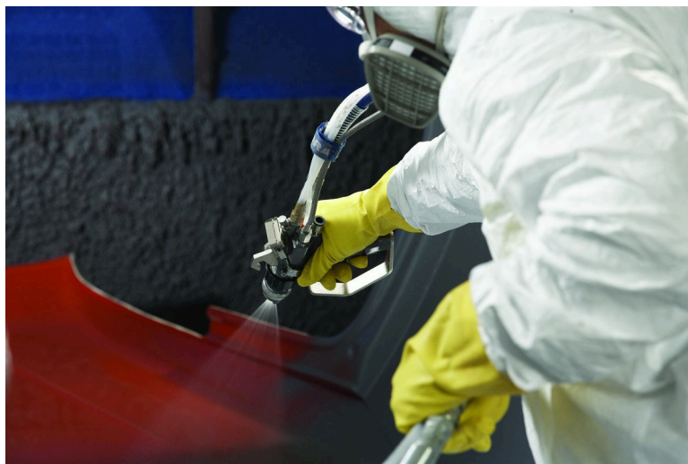
Figura 2 - Exemplo da aplicação de gel coat em molde aberto
