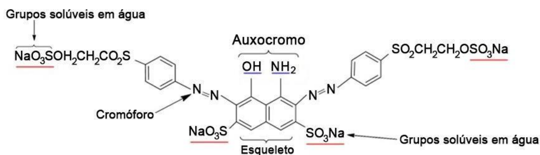
Figura 1. Estrutura química típica encontrada em corantes azo. Fonte: Adaptado e traduzido de BENKHAYA; M'RABET; EL HARFI, 2020.
