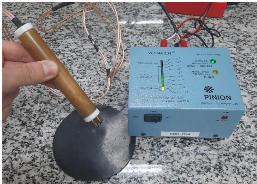
Figura 3.2.8.2. Detalhes dos polos na extremidade do equipamento PINION VOYAGER.
