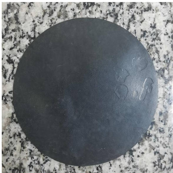
Figura 3.2.3.1. Placa moldada por compressão de amostra com negro de fumo.
