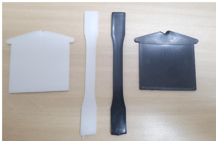
Figura 3.2.2.1. Corpos de prova sem e com negro de fumo, injetados em moldes tipo casinha e tração ASTM 638.
