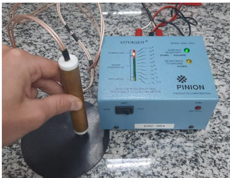
Figura 3.2.8.3. Imagem da análise de resistividade utilizando o equipamento PINION VOYAGER.
