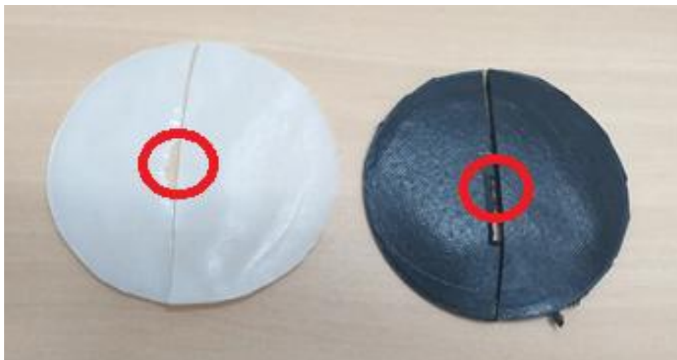
Figura 3.6.2.2. Placas moldadas por compressão no formato de disco e posição de central (C) de onde foram coletadas frações para análise de DSC.
