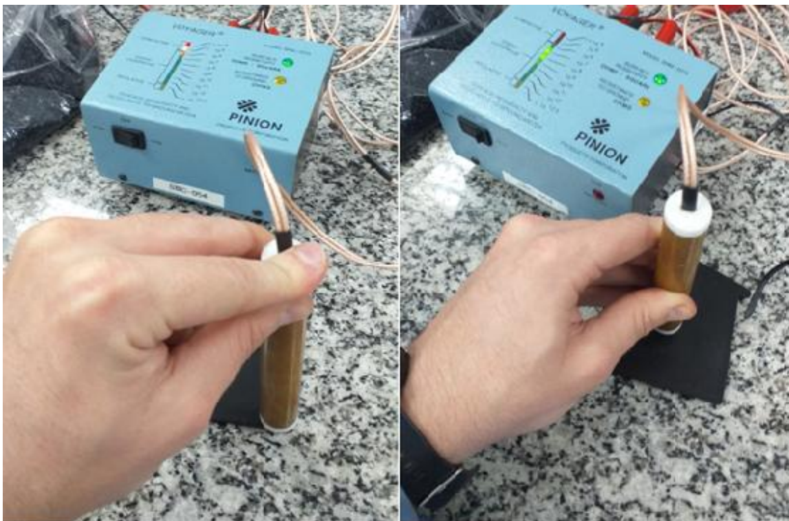
Figura 4.5.1. Resistividade elétrica de amostra 3, mostrado resistividade elétrica de 10^5 \Omega \cdot \text{cm} na extremidade (foto à esquerda) e 10^7 \Omega \cdot \text{cm} no centro (foto à direita).
