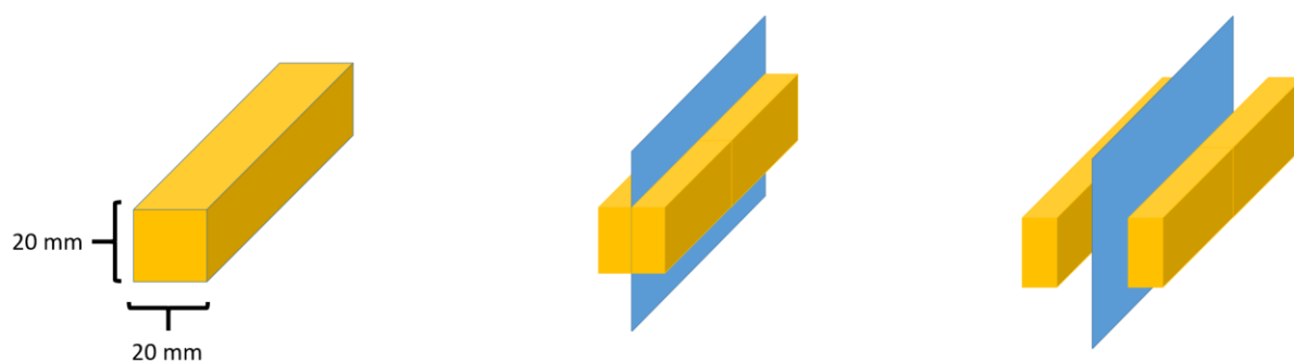
Figura 7 – Esquema de corte realizado, para revelar a face de interesse utilizada na análise.
