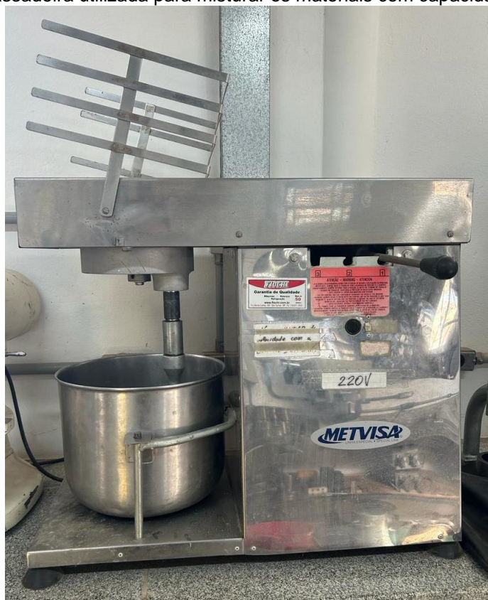
Figura 10 - Argamassadeira utilizada para misturar os materiais com capacidade total de 10 litros.
