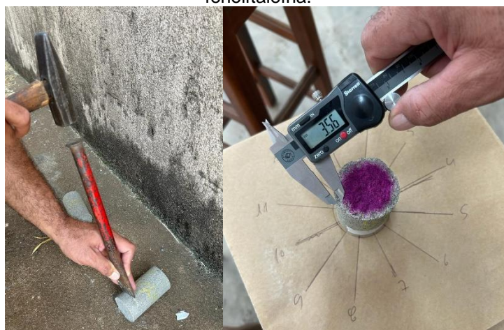
Figura 21 - a) CP sendo quebrado; b) Leitura da frente de carbonatação após aspersão de fenolftaleína.
