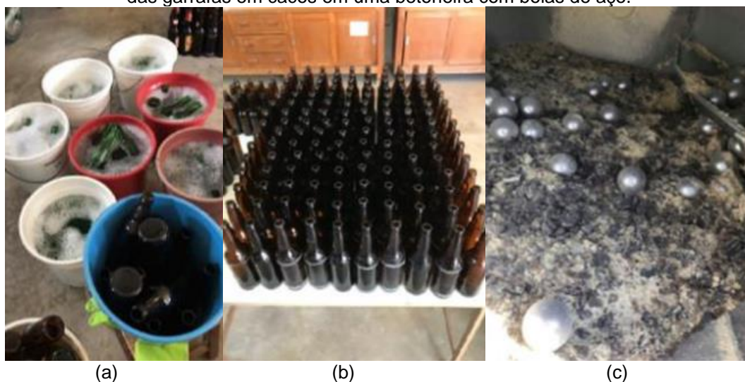
Figura 6 - a) Lavagem e retirada dos rótulos das garrafas; b) Secagem ao ar das garrafas; c) Quebra das garrafas em cacos em uma betoneira com bolas de aço.
