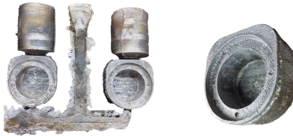
Figura 27 – Sistema bruto da fusão e peça após extração do sistema Fonte: Autoria Própria
