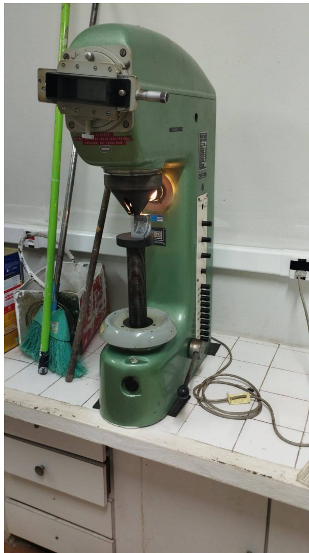
Figura 36 – Equipamento usado para realizar ensaio de dureza Fonte: Autoria Própria
