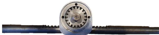
Figura 39 – Peça final montada no conjunto do sistema de direção do veículo baja Fonte: Autoria Própria
