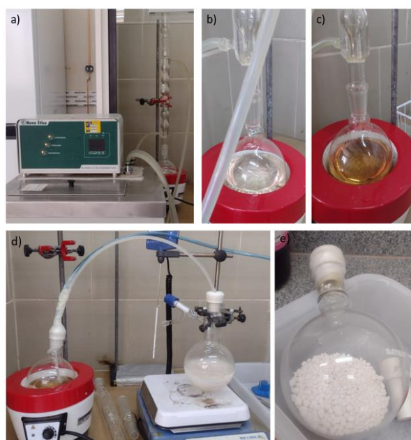
Figura 5.12: Sistema de síntese do [BMim]Cl (a), cor da solução no início da síntese (b) e após 48horas (c), sistema para a precipitação do líquido iônico (d) e produto obtido após evaporação do solvente (e).
