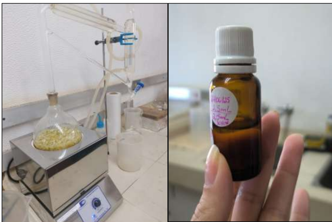
Figura 9. Extração de óleo essencial da casca de laranja Pêra e frascos de vidro âmbar contendo óleo essencial de laranja Pêra. Fonte: autor, 2025
