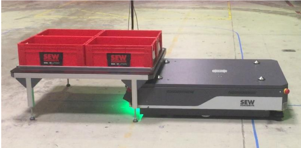
Figura 26: Estrutura metálica para AGV tipo deck lift
