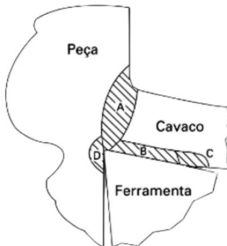
Figura 6 – Zonas de geração de calor
