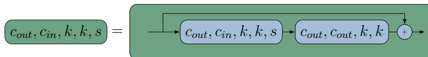
Figura 2.4 – Esquema básico de um bloco residual. O segundo bloco convolucional tem sua saída somada ao valor de entrada, permitindo que o bloco se comporte como a função identidade se necessário.
