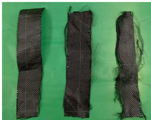
Figura 50 - Fotografia dos tecidos de fibras de carbono obtidas após o tratamento térmico para a remoção da resina epóxi nos pré-impregnados. Da esquerda para a direita: FC-450, FC-500 e FC-600
