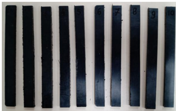
Figura 42 - Fotografia dos corpos de prova para o ensaio de flexão
