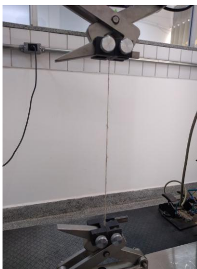
Figura 9 - Fotografia do cordão de fibras de juta preso na garra do equipamento de ensaio de tração
