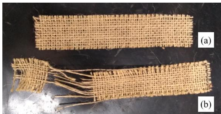
Figura 14 - Fotografias do: (a) tecido antes do ensaio de tração, e (b) após o ensaio de tração
