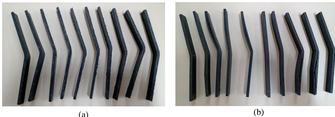
Figura 51 - Fotografias dos 10 corpos de prova do: (a) compósito contendo uma camada do tecido rFC (rABS/1rFC); (b) compósitos contendo duas camadas do tecido rFC (rABS/2rFC) após o ensaio de flexão
