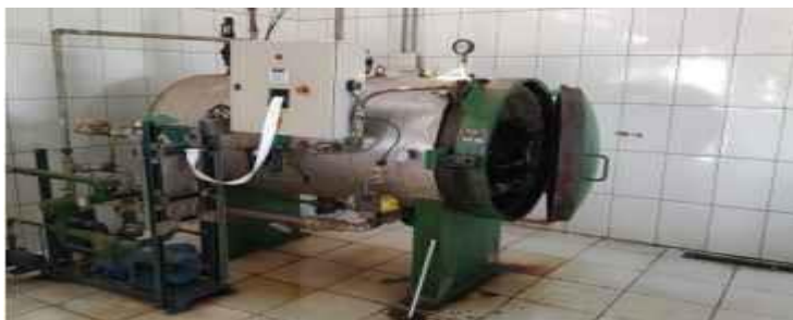
Figura 3: Autoclave localizada na unidade de tratamento de Resíduos de Serviços de Saúde em São Carlos (SP)
