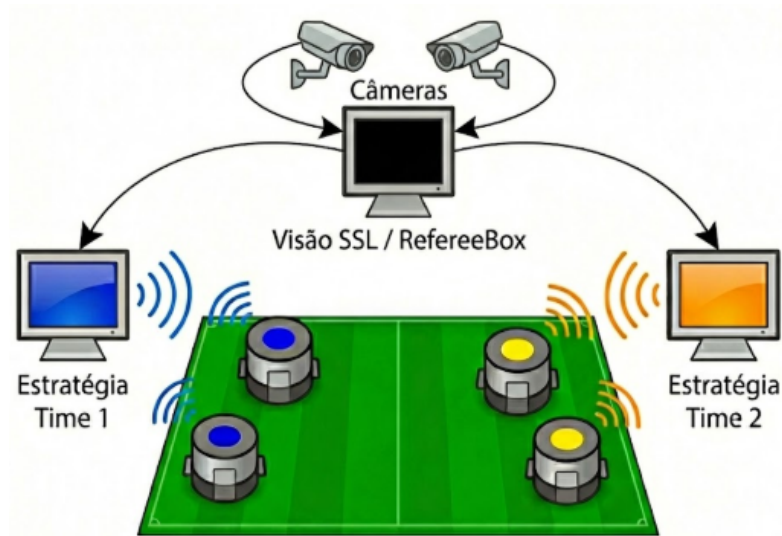
Figura 2 – Fluxo de comunicação entre os principais elementos da SSL
