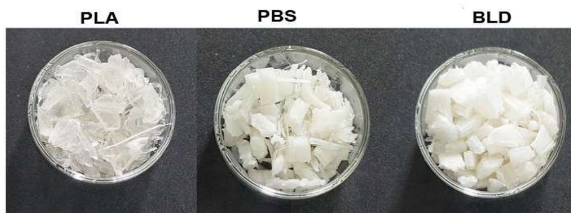
Figura 3.3: Aspecto visual do material utilizado para impressão 3D dos scaffolds .
