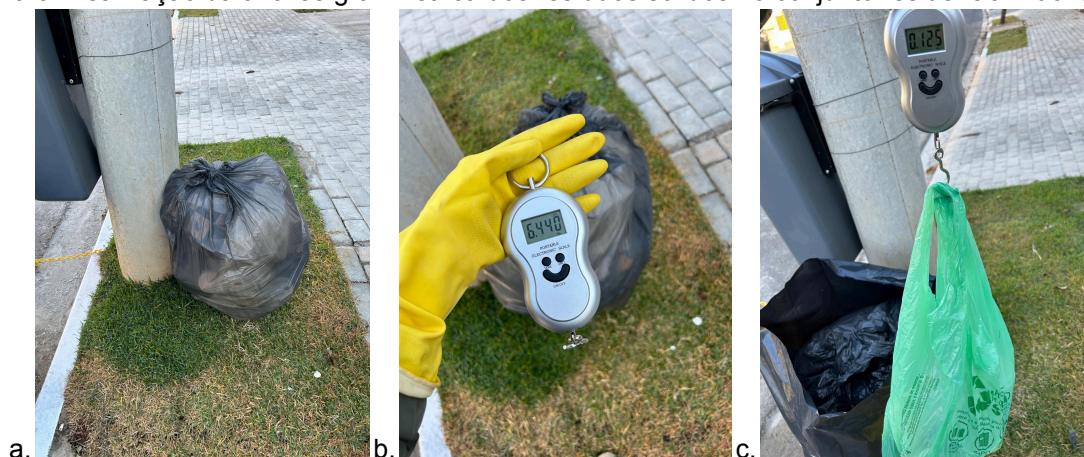
Figura 5: Realização da análise gravimétrica dos resíduos sólidos no conjunto residencial Buona Vita.
