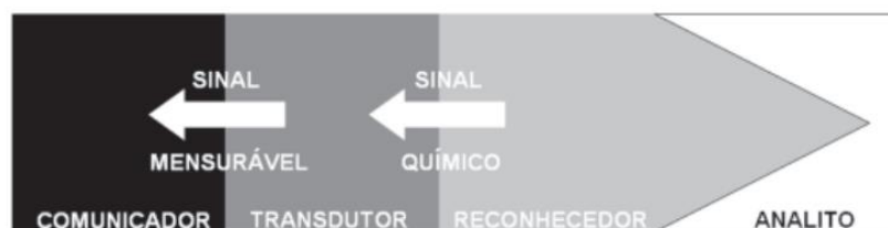
Figura 6 - Esquema geral dos principais componentes de um sensor químico
