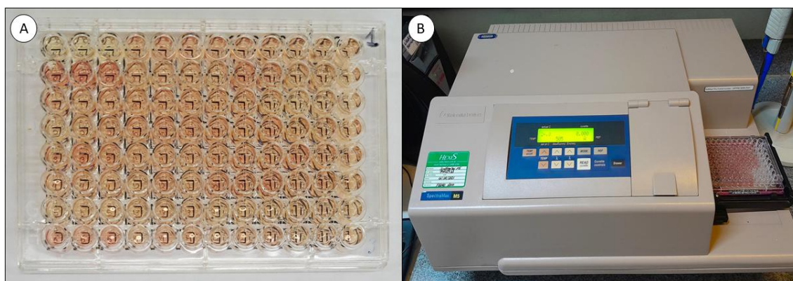
Figura 7 – Microplaca após a adição do reagente de triglicerídeos (A) e espectrofotômetro (Laboratório de Zoofisiologia e Bioquímica Comparativa – UFSCar, responsável: Profa. Dra. Marisa Narciso Fernandes) (B). Fonte: elaborada pelo autor.
