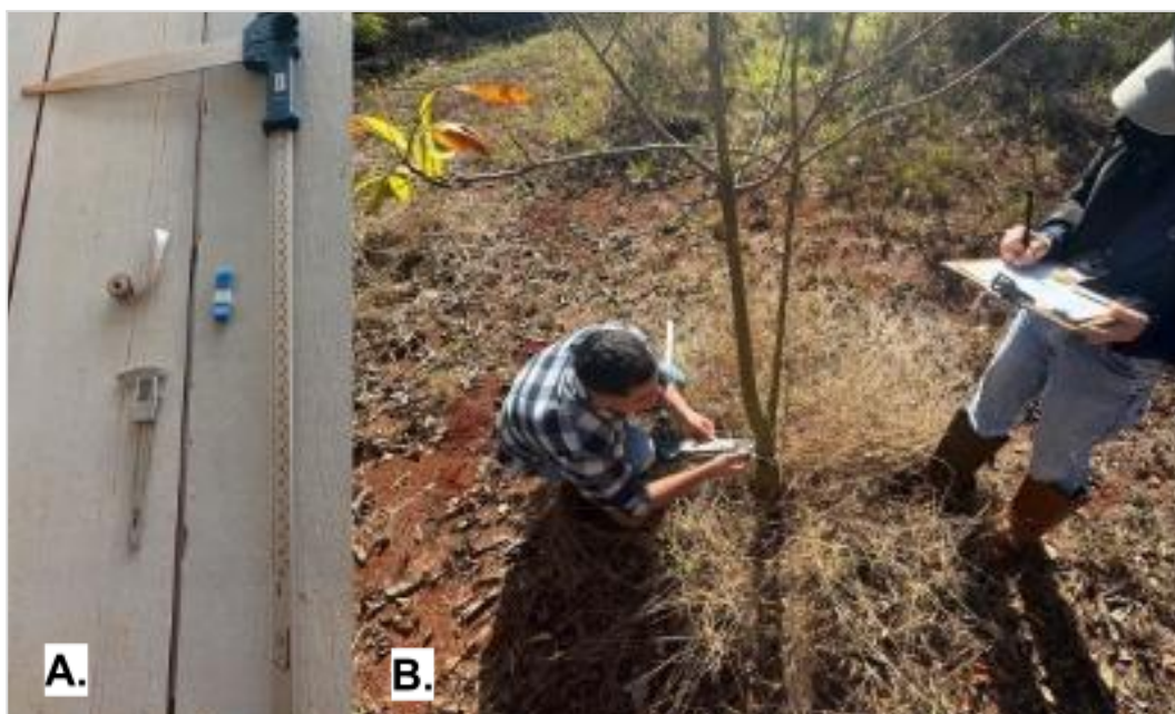
Figura 3. a) Paquímetro, SUTA e fitas métricas; b) Medição de diâmetro à 30 cm do solo.
