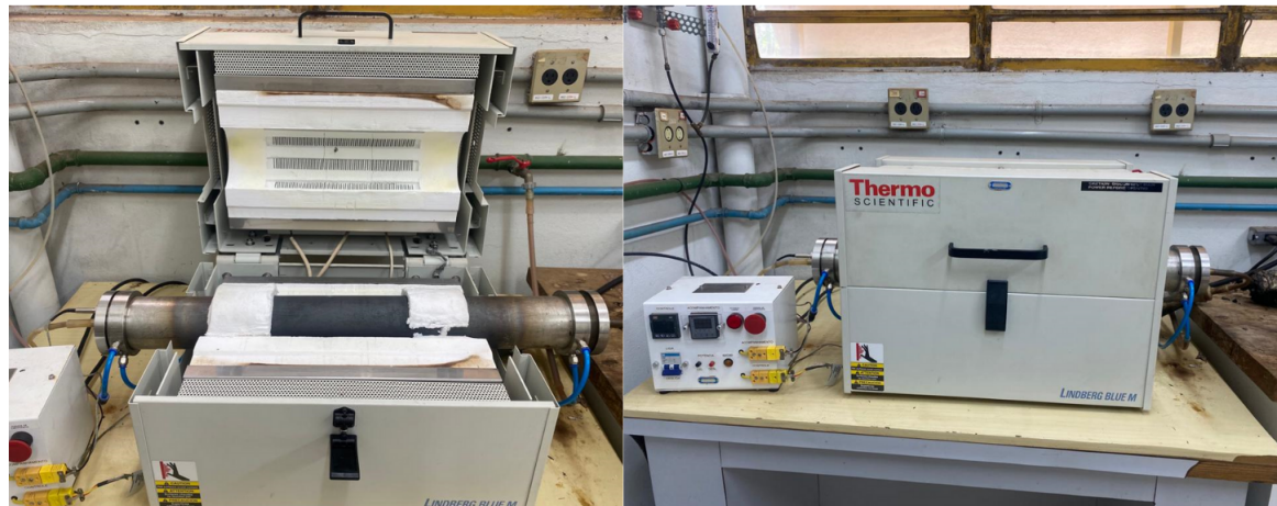
Figura 13 – Imagens do reator de pirólise (Thermo Scientific Lindberg, modelo Blue M 1100C Tube Furnace). Fonte: Autoria própria
