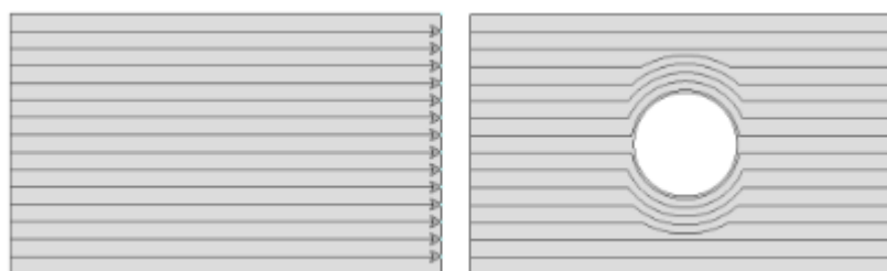
Figura 3 – Representação de linhas de fluxo em chapa com concentrador de tensão
