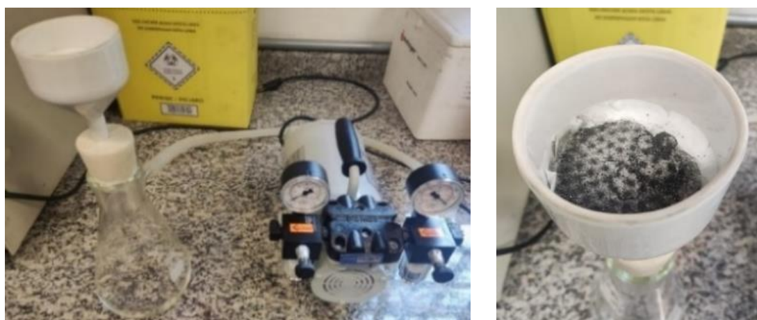
Figura 17 – Sistema com bomba de vácuo e funil de Buchner com papel filtro utilizados.
