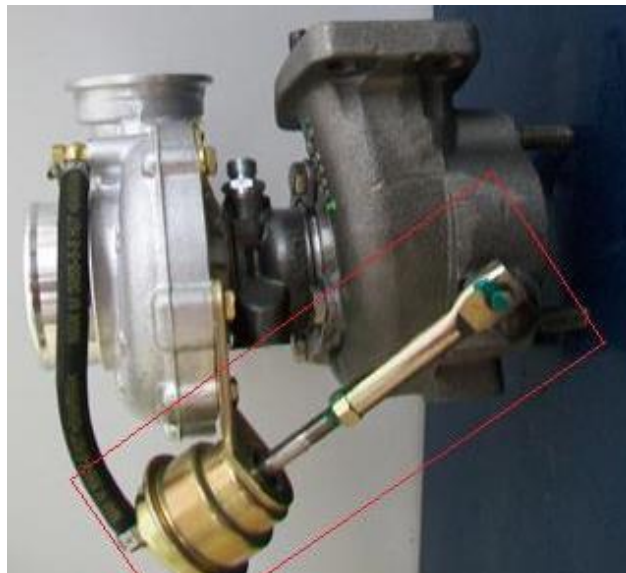
Figura 16 - Turbocompressor equipado com uma válvula wastegate pneumática.
