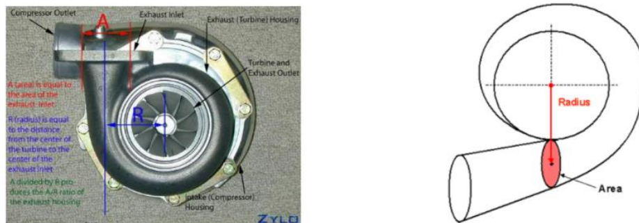
Figura 18 - Relação Área/Raio da turbina.
