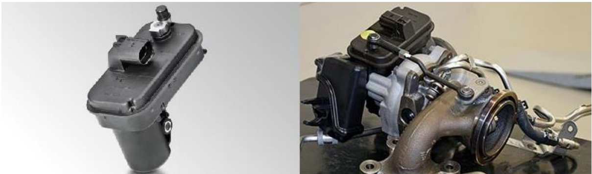
Figura 17 - Atuador de posição da válvula wastegate (esquerda) e conjunto do atuador na turbina (direita).
