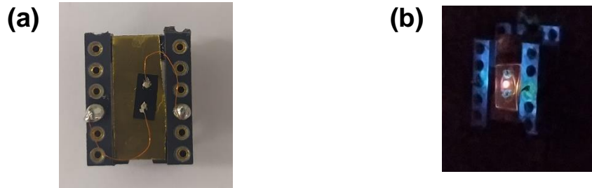
Figura 2.9 (a) Filme de \text{Co}_3\text{O}_4 no porta amostra com contato elétrico de difusão de estanho e fios de cobre. (b) Filme de ZN10 sob iluminação óptica (laser 325 nm) durante a medida de fotocondutividade – contatos elétricos preparados com tinta prata e fios de cobre. (FONTE: Fotografias tiradas pelo autor).
