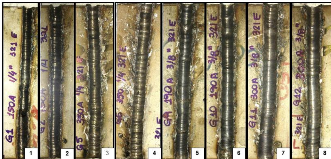
Figura 4.5 Superfícies goivadas de aço inoxidável AISI 321 goivadas com parâmetros da Tabela 4.3.
