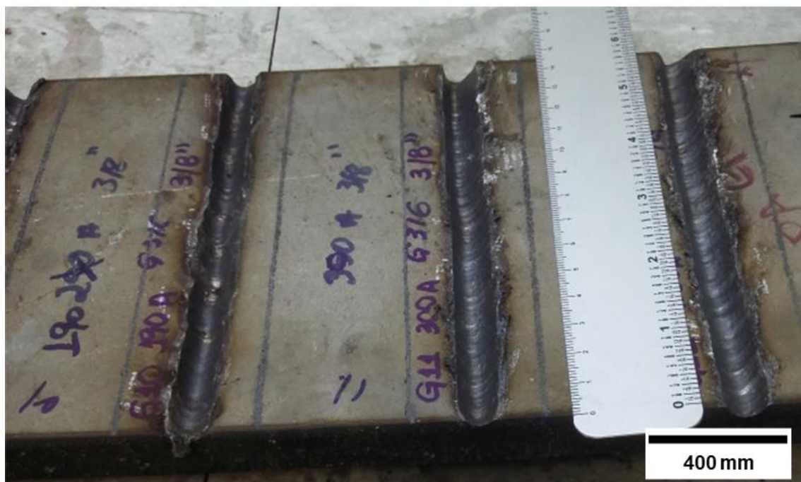
Figura 5.4. Imagem da chapa pós goivagem referente ao estudo de parâmetros de diâmetro de eletrodo e corrente de goivagem.
