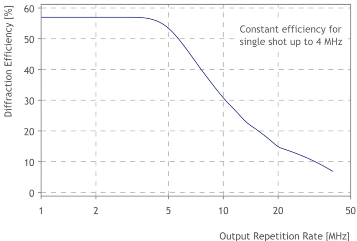
Figura 8 – Eficiência do feixe de saída do pulse picker em função da frequência. Fonte: APE-Berlin
