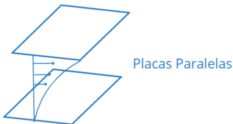
Figura 1 - Deslocamento de Placas Paralelas Levando o Fluido a Entrar em Escoamento não Linear
