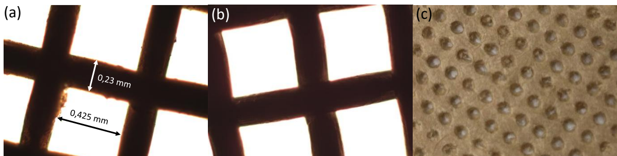
Figura 9. Microscopia óptica com ampliação de 5x dos substratos utilizados para deposição das fibras onde: (a) tela de cobre; (b) tela de alumínio. (c) Imagem da tela de celulose.
