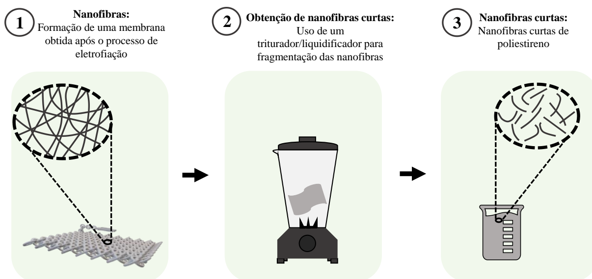
Figura 19. Processo de produção de nanofibras curtas utilizando um triturador.
