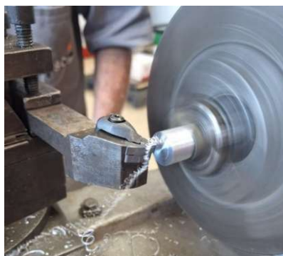
Figura 18 - Fabricação dos corpos de prova: Faceamento.
