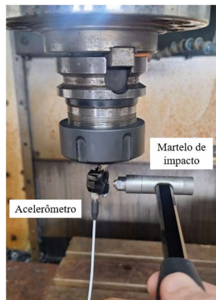
Figura 20 - Ensaio experimental para geração da FRF .
